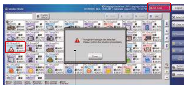
Wyskakujące okienko z informacją o wycieku
